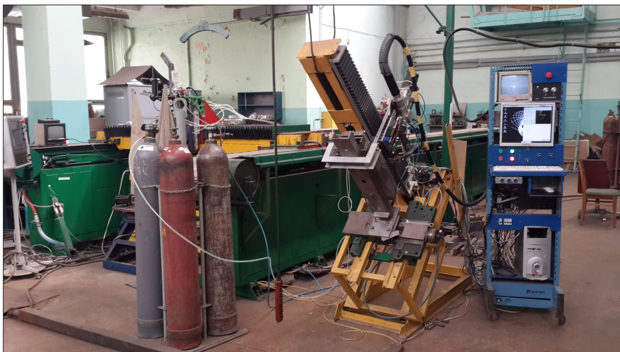
Рис. 2. Лабораторний стенд для лазерного зварювання у різних просторових положеннях
